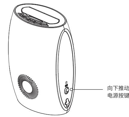
请推动主机侧面的开关, 打开电源使用。
