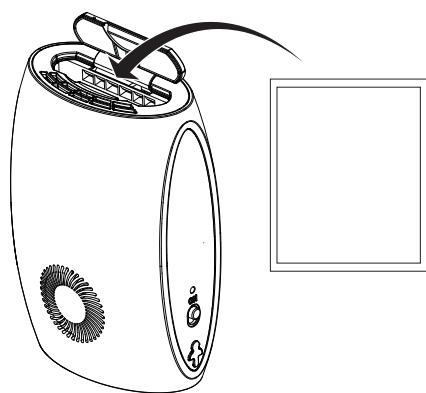
将主体顶部的耗材盖打开,
